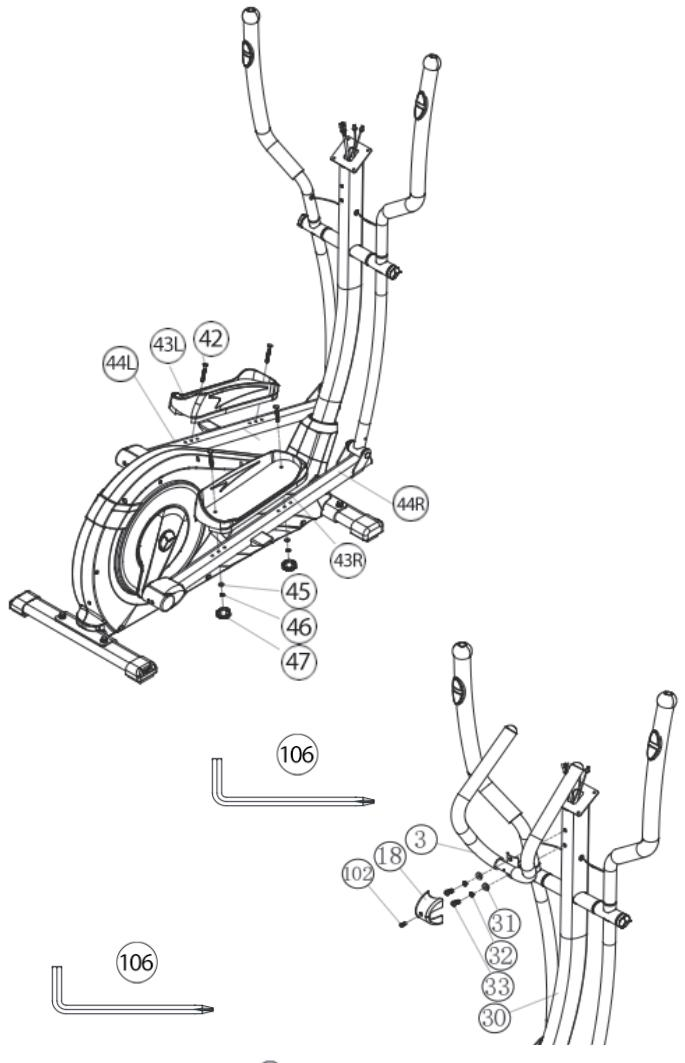
**Schritt 6:****Montage des Haltegriffes (3) am Stützrohr (30).**
