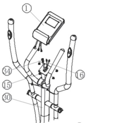
**Schritt 7:****Montage des Computers (1) am Stützrohr (30).**
